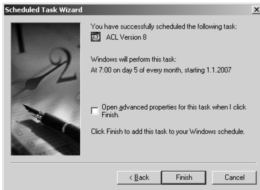
Slika 5: določitev izvajanja ACL paketa v Task scheduler-ju v MS Windows-ih.
